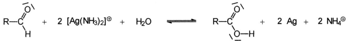
**Abbildung 3:** Das Aldehyd der Glucose reduziert die Silberionen(I) ( $\text{Ag}^+$ ) zu elementarem Silber (Ag). Bei dieser Reaktion oxidiert Aldehyd (CHO) zur Carbonsäure(COOH).
