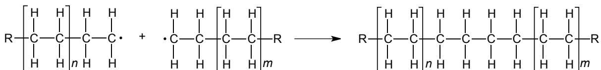
Abbildung 14: Mechanismus der radikalischen Polymerisation am Beispiel der Bildung von PE
