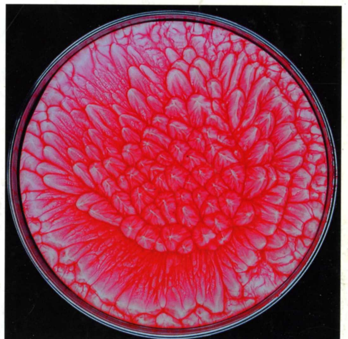
Abb. 7: Musterbildung durch Luftoxidation des Farbstoffes Safranin in alkoholischer Lösung. Die Animation der Musterentstehung aus einer homogenen Lösung kann bei [5] betrachtet werden.
