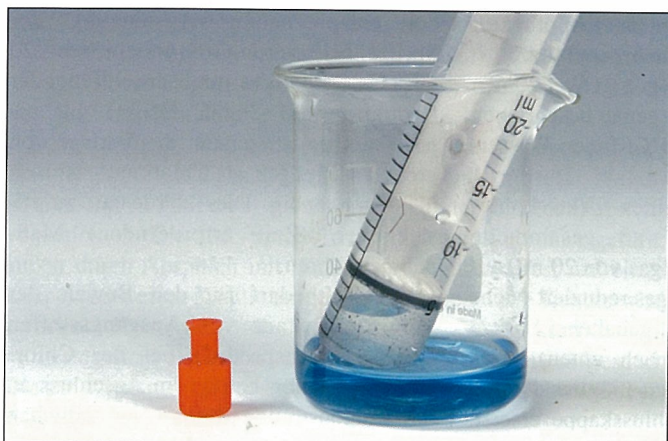
Abb. 21: Reaktion von 5 mL Chlorwasserstoff mit Wasser - die Verschlusskappe darf nur unter Wasser geöffnet werden.
