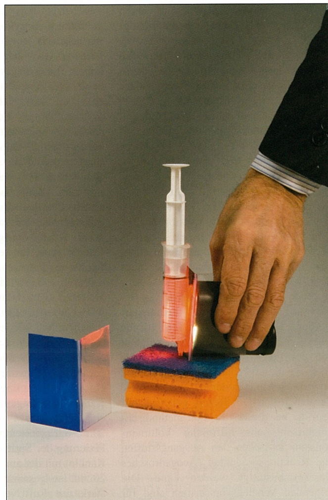
Abb. 18: Fotolytischer Zündversuch von 10 mL Chlorknallgas mit Elektronenblitz und Rotfilter bzw. Blaufilter
