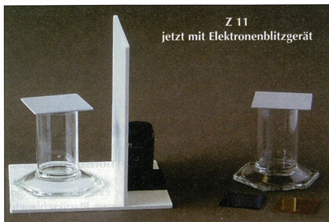
Abb. 8 (aus [22]): Kurzer, breiter Standzylinder, pneumatisch mit Chlorknallgas zu füllen, belichtet mit Elektronenblitz mit Farbfilter (Preis des Sets: 159 )
