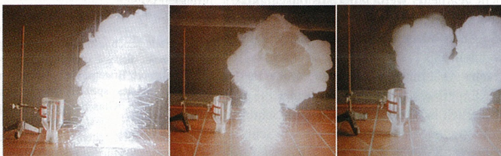
Abb. 5: Reaktion der Magnesium-Kaliumchlorat-Mischung zur Zündung des Chlorknallgas-Gemisches.
