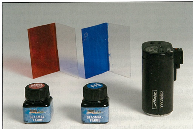
Abb. 17: Transparente Glasmalfarbe Fa. Hobby-Line dunkelrot und blau, PVC-Folie 0,4 mm rechtwinklig gebogen und bemalt, Elektronenblitz Metz Leitzahl 20.
