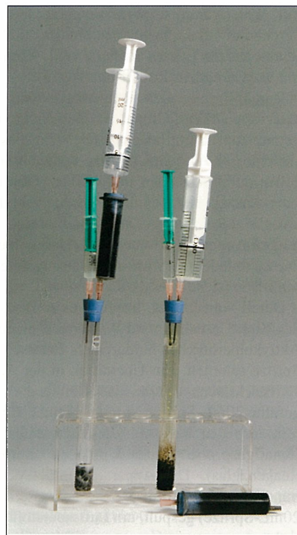
Abb. 16: Low-Cost-Gasentwickler n. Obendrauf zur Gewinnung von HCl-freiem Wasserstoff (links) bzw. Chlorgas, mobil und mit Aktivkohleröhrchen als Ersatz für einen Abzug(rechts)
